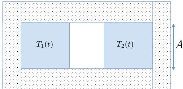
L'aire latérale de la couche d'air entre deux blocs est  $A$ . Le rayonnement émis par les blocs est caractérisé par la loi de Stefan-Boltzmann. Par conséquent, la puissance thermique  $P_Q^{ij}$  exercée par le bloc  $i$  à température  $T_i(t)$  sur le bloc  $j$  à température  $T_j(t)$  est donnée par,
